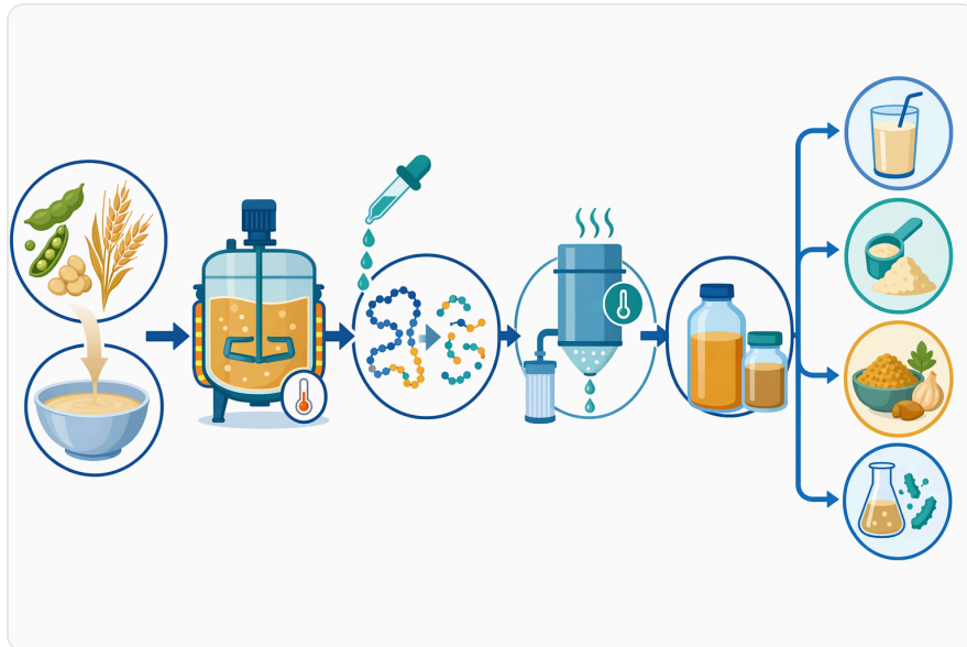
Figure 7. 일반적인 파파인 가수분해 공정은 식물성 단백질을 수화한 뒤 효소를 첨가하고, 접촉 시간을 조절하며, 반응을 비활성화한 다음 가수분해물을 혼합, 가열, 건조하거나 제형화하는 과정으로 이루어집니다.
