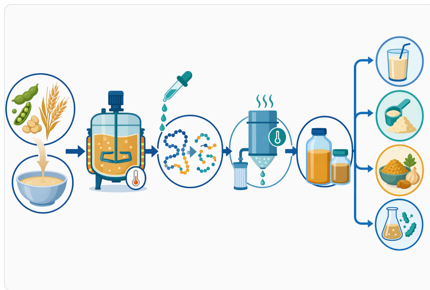
Figure 7. 일반적인 파파인 가수분해 공정은 식물성 단백질을 수화하고, 효소를 첨가한 뒤, 접촉 시간을 조절하고, 반응을 비활성화한 다음, 가수분해물을 혼합, 가열, 건조하거나 제형화하는 과정으로 이루어집니다.
