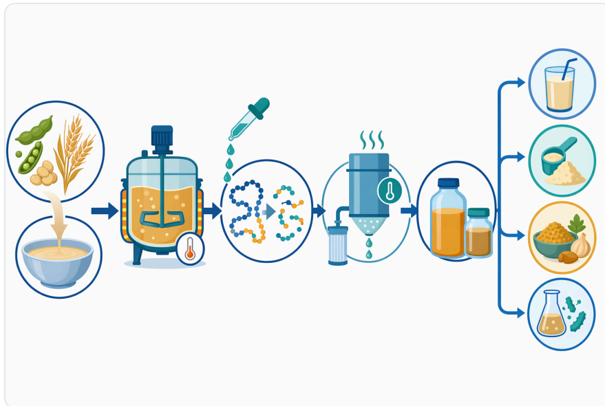
Figure 7. 일반적인 파파인 가수분해 공정은 식물성 단백질을 수화한 뒤 효소를 첨가하고, 접촉 시간을 조절하며, 반응을 비활성화한 다음 가수분해물을 혼합, 가열, 건조하거나 제형화하는 단계로 이루어집니다.
