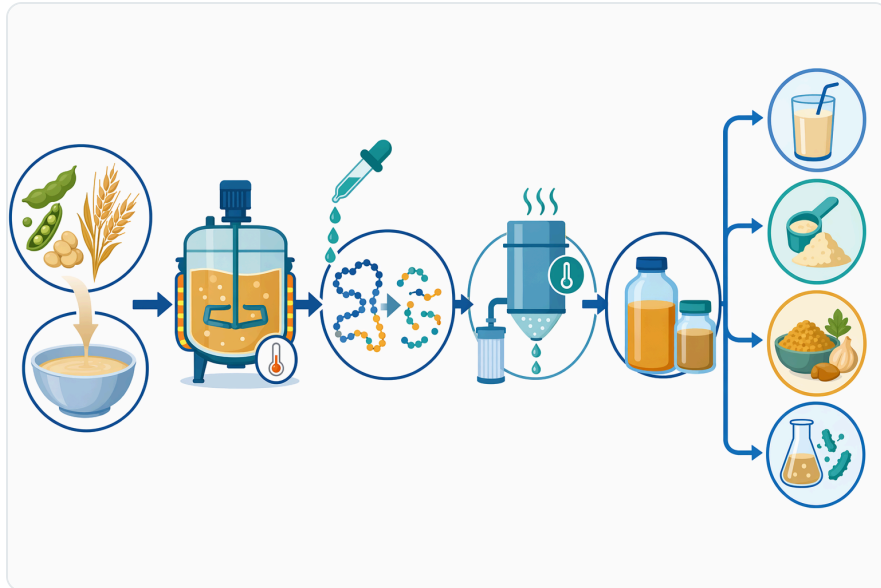
Figure 7. 일반적인 파파인 가수분해 공정은 식물성 단백질을 수화하고, 효소를 첨가한 뒤, 접촉 시간을 조절하고, 반응을 불활성화한 다음, 가수분해물을 혼합, 가열, 건조하거나 배합하는 과정으로 이루어집니다.
