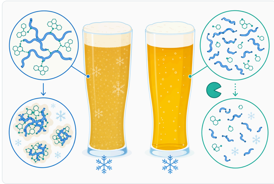
Figure 4. 매시 단계에서 프로테아제를 처리하면 민감한 단백질 분획의 크기와 교차결합 능력을 줄여 단백질-폴리페놀 혼탁에 관여하는 물질 풀을 낮추는 데 도움이 될 수 있다.
