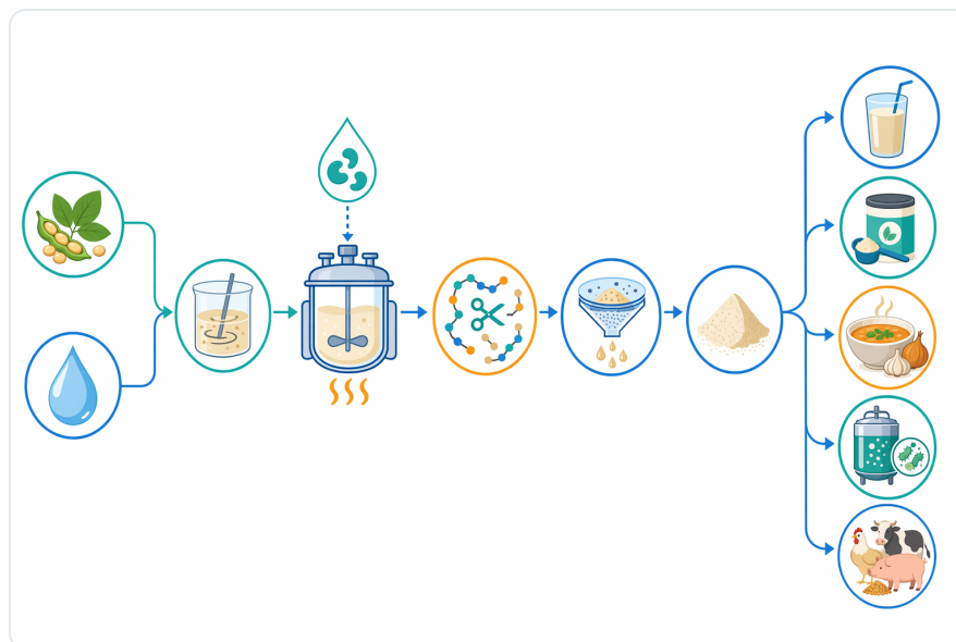
Figure 2. Quy trình thủy phân protein thực vật trong công nghiệp thường bao gồm chuẩn bị huyền phù protein, xử lý bằng protease trung tính, tách, sấy khô và phối chế thành các sản phẩm thực phẩm, thức ăn chăn nuôi và sản phẩm lên men.
