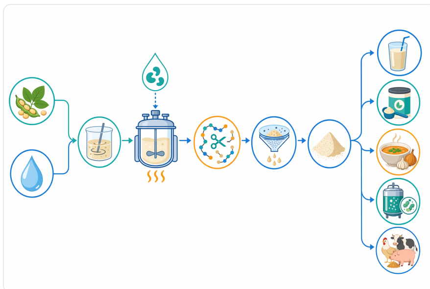
Figure 2. 산업용 식물성 단백질 가수분해 공정은 일반적으로 단백질 슬러리 제조, 중성 프로테아제 처리, 분리, 건조, 그리고 식품·사료·발효 제품으로의 제형화를 포함합니다.
