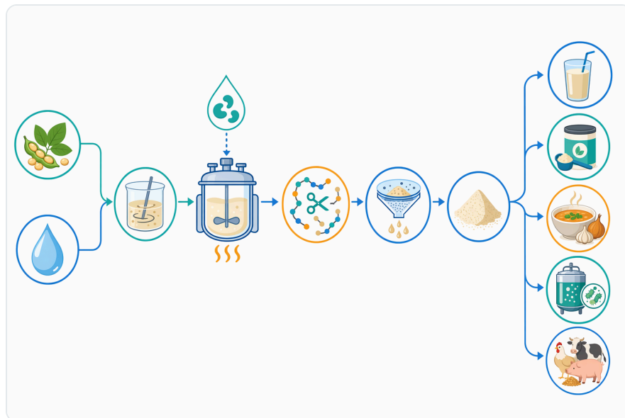
Figure 2. 산업적 식물성 단백질 가수분해 공정은 일반적으로 단백질 슬러리 준비, 중성 프로테아제 처리, 분리, 건조, 그리고 식품·사료·발효 제품용 제형화를 포함합니다.
