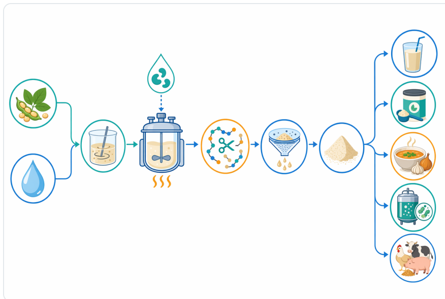
Figure 2. 산업적 식물성 단백질 가수분해 공정은 일반적으로 단백질 슬러리 제조, 중성 프로테아제 처리, 분리, 건조, 그리고 식품·사료·발효 제품용 제형화를 포함한다.
