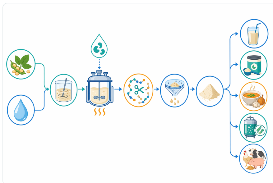
Figure 2. 산업용 식물성 단백질 가수분해 공정은 일반적으로 단백질 슬러리 제조, 중성 프로테아제 처리, 분리, 건조, 그리고 식품·사료·발효 제품용 제형화를 포함합니다.
