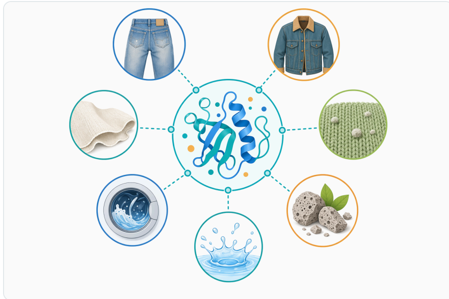
Figure 3. 중성 셀룰라아제는 주로 데님 바이오 스톤워싱, 면 소재의 유연 가공, 표면 보풀 제거, 부석 사용량 감소에 사용됩니다.
