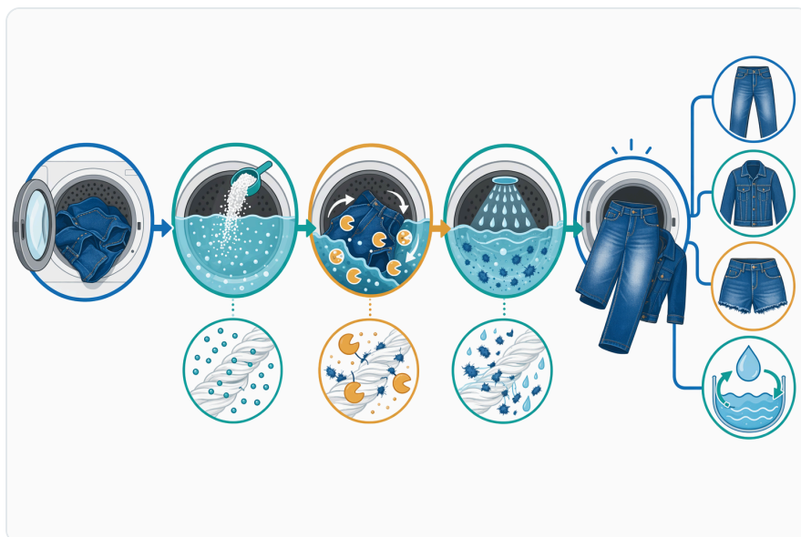
Figure 2. 의류 워싱 공정에서 중성 셀룰라아제를 데님 처리액에 첨가하면 바이 오 스톤 워싱 효과, 부드러운 촉감, 국부적인 탈색 효과를 얻을 수 있습니다.
