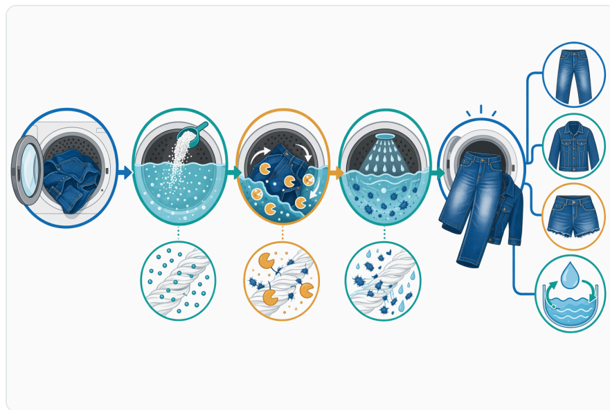
Figure 2. 의류 워싱 공정에서 중성 셀룰라아제는 데님 워싱액에 첨가되어 바이오 스톤워싱 효과, 부드러운 촉감, 국부적인 페이딩 효과를 구현합니다.
