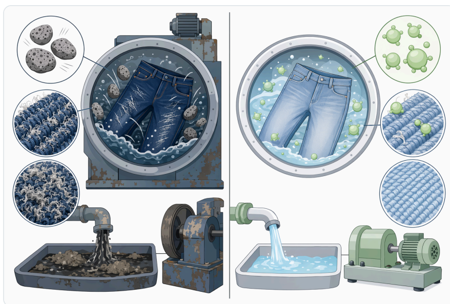
Figure 4. 부석만을 사용한 마모 공정과 비교하면, 중성 셀룰라아제를 이용한 데님 워싱은 원단 손상을 줄이고 고형 폐기물을 낮추면서 더 제어된 탈색 효과를 제공합니다.
