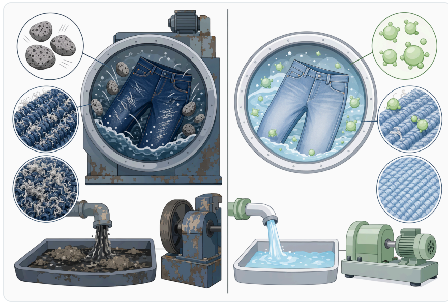
Figure 4. 부석만을 사용한 마모 공정과 비교했을 때, 중성 셀룰라아제를 이용한 데님 워싱은 원단 손상이 적고 고형 폐기물이 줄어들며 더 제어된 페이딩 효과를 제공합니다.
