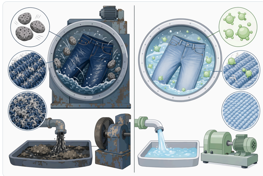
Figure 4. 부석만을 사용한 마모 공정과 비교했을 때, 중성 셀룰라아제를 이용한 데님 워싱은 원단 손상이 적고 고품 폐기물이 적으면서도 더 제어된 페이딩을 제공합니다.
