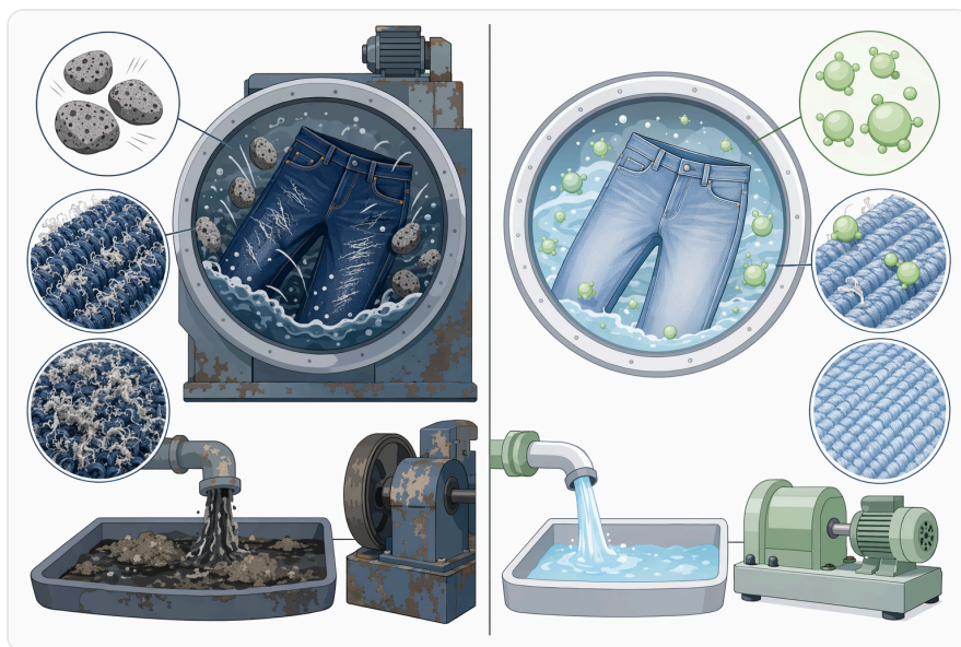
Figure 4. 부석만을 사용하는 마모 공정과 비교할 때, 중성 셀룰라아제를 이용한 데님 워싱은 원단 손상을 줄이고 고형 폐기물을 낮추면서 더 제어된 페이딩 효과를 제공합니다.
