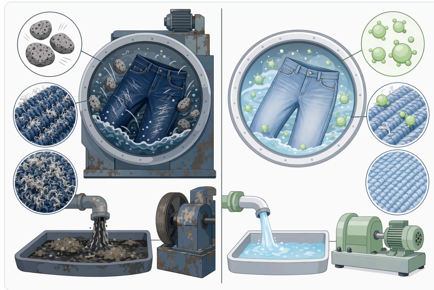
Figure 4. 부석만을 사용하는 마모 공정과 비교해, 중성 셀룰라아제를 이용한 데님 워싱은 원단 손상이 적고 고형 폐기물이 줄어들며 더 균일하게 조절된 워싱 효과를 제공합니다.
