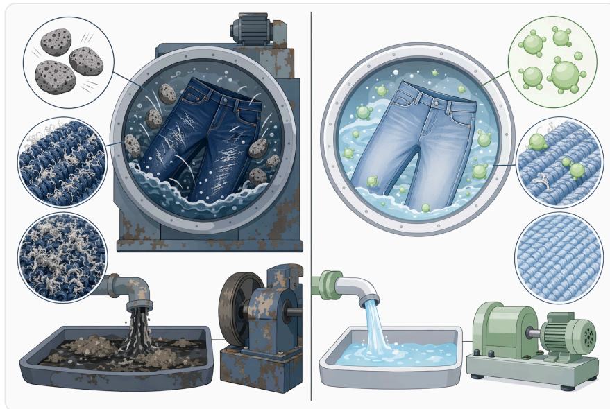
Figure 4. 부석만을 사용한 마모 처리와 비교할 때, 중성 셀룰라아제 데님 위싱은 원단 손상이 적고 고�형 폐기물이 적게 발생하면서도 더 제어된 페이딩 효과를 제공합니다.
