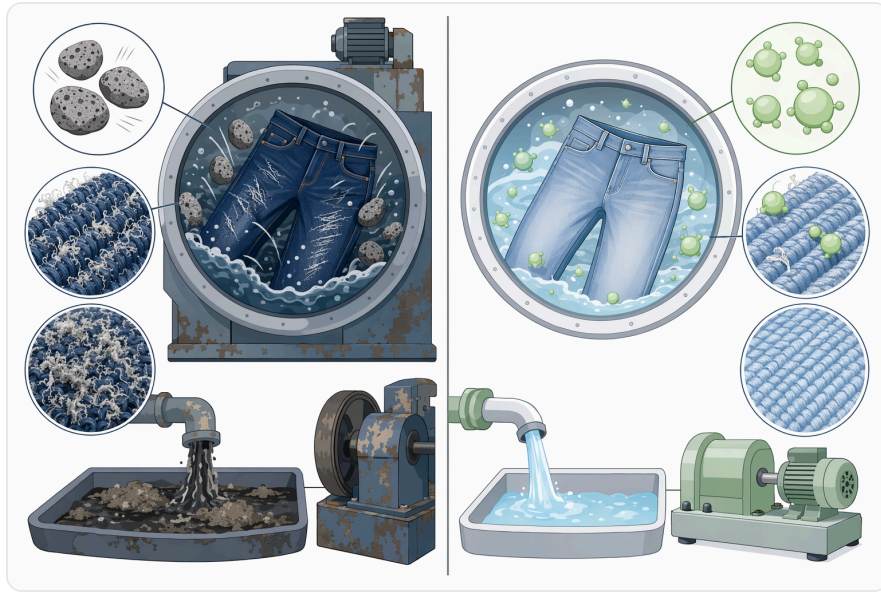
Figure 4. 부석만을 사용하는 마모 공정과 비교할 때, 중성 셀룰라아제 데님 워싱은 원단 손상이 적고 고품 폐기물이 적으면서도 더 제어된 페이딩을 제공합니다.
