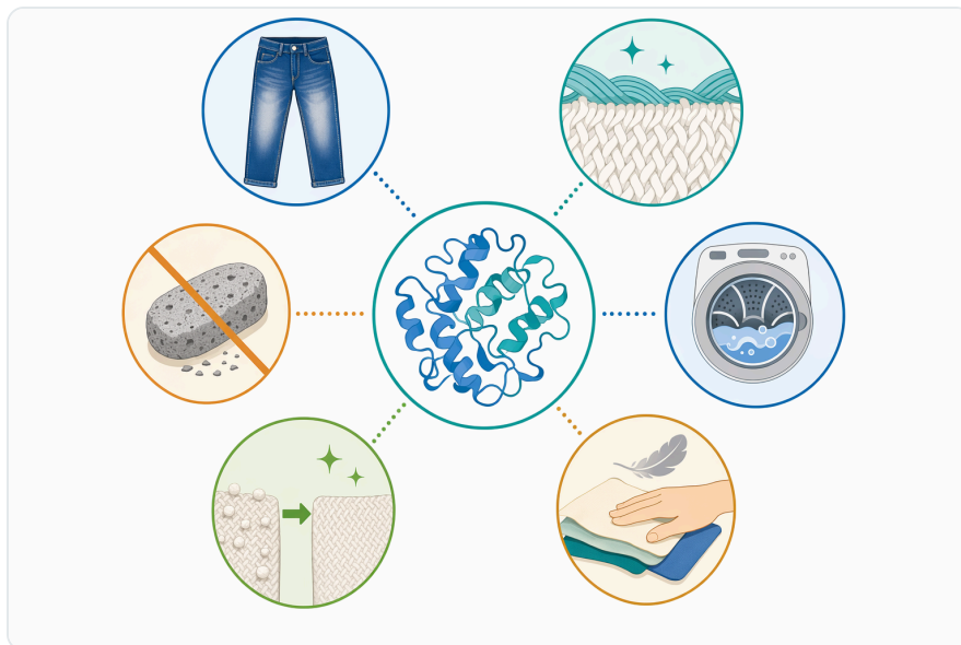
Figure 6. 中性纖維素酶可用於棉含量高的丹寧，呈現乾淨的深色水洗、中度舊化效果、縫線與邊緣的打亮、較柔軟的手感，以及石洗效果。
