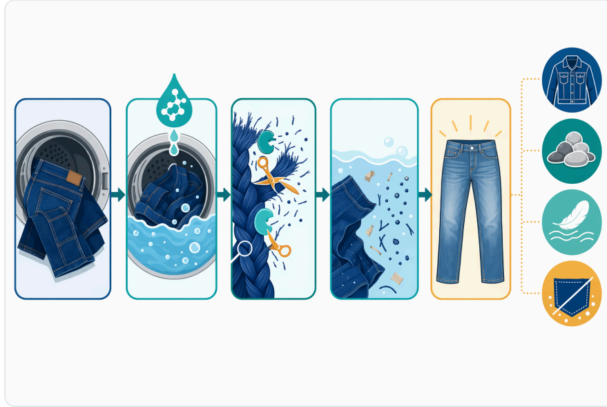
Figure 5. 최종 데님 효과는 준비, 효소 접촉, 기계적 마모, 헹굼 또는 효소 제거, 마무리로 이어지는 세탁 공정의 조합에 따라 달라집니다.
