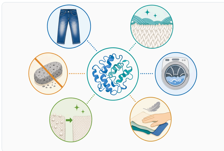
Figure 6. 중성 셀룰라아제는 면 함량이 높은 데님에서 깔끔한 다크 린스, 적당히 오래 입은 듯한 느낌, 솔기와 가장자리의 하이라이트, 더 부드러운 촉감, 스톤워싱 효과를 구현하는 데 도움이 될 수 있습니다.
