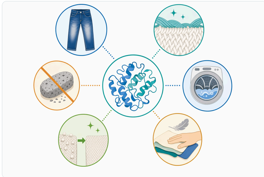
Figure 6. 중성 셀룰라아제는 면 함량이 높은 데님에서 깔끔한 다크 린스, 적당히 오래 입은 듯한 느낌, 솔기와 가장자리의 하이라이트, 더 부드러운 촉감, 스톤워싱 효과를 구현하는 데 도움이 될 수 있다
