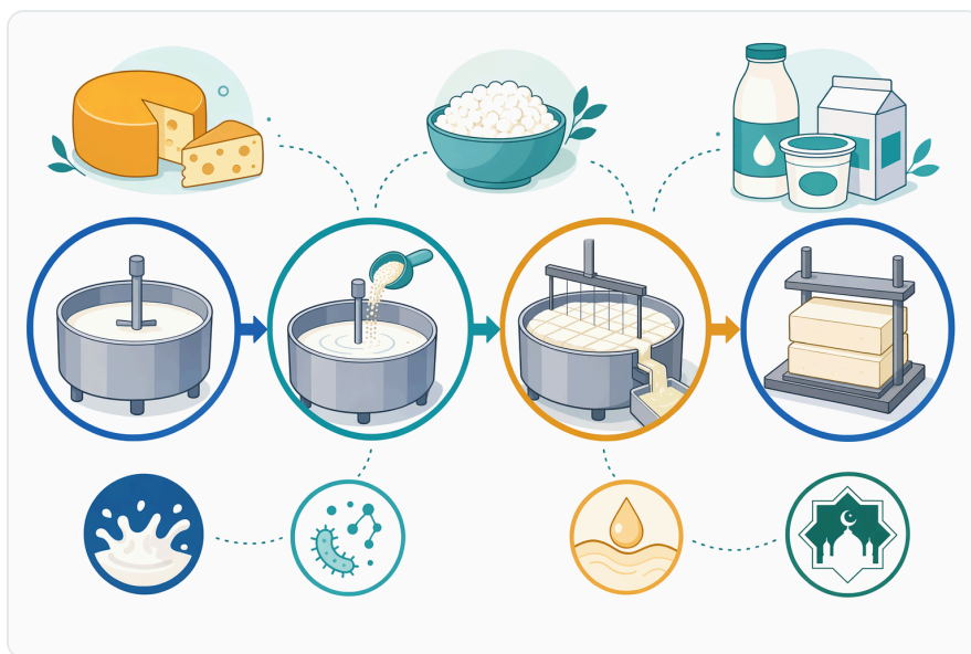
Figure 6. 제조 탱크에서는 준비된 우유를 배양하거나 조정된 뒤 렌넷을 고르게 분산시키고, 겔이 흔들림 없이 형성되도록 한 다음 커드를 절단하여 조절된 유청 배출을 시작한다.
