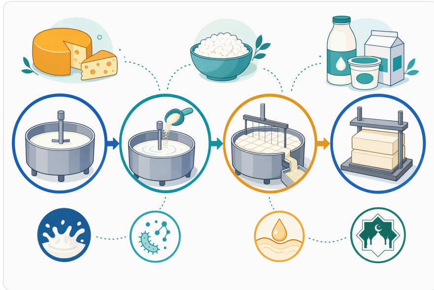
Figure 6. 제조 탱크에서는 준비된 우유를 배양하거나 조정된 뒤 레닛을 분산시키고, 젤이 흔들림 없이 형성되도록 한 다음 커드를 절단하여 유청 배출을 조절하기 시작합니다.
