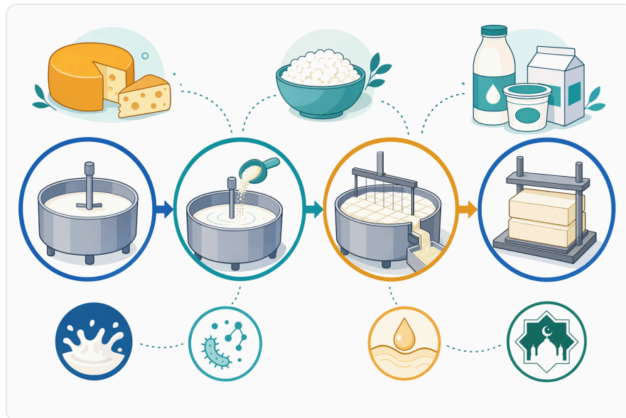
Figure 6. 치즈 배트에서는 준비된 우유를 배양하거나 조건화한 뒤 레닛을 고르게 분산시키고, 겔이 흔들림 없이 형성되도록 한 다음 커드를 절단해 유청 배출을 조절하기 시작합니다.
