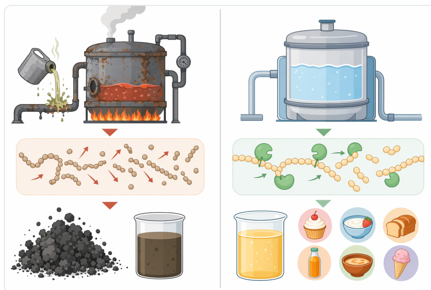
Figure 4. 산을 이용한 전분 가수분해와 비교하면, 알파-아밀라아제 액화는 더 온화한 공정 조건, 더 제어된 덱스트린 형성, 더 적은 불필요한 부산물을 제공합니다.
