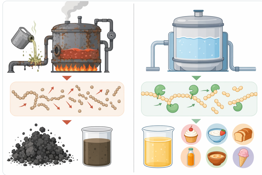
Figure 4. 산을 이용한 전분 가수분해와 비교할 때, 알파-아밀라아제 액화는 더 온화한 공정 조건, 더 제어된 덱스트린 형성, 그리고 더 적은 바람직하지 않은 부산물을 제공합니다.
