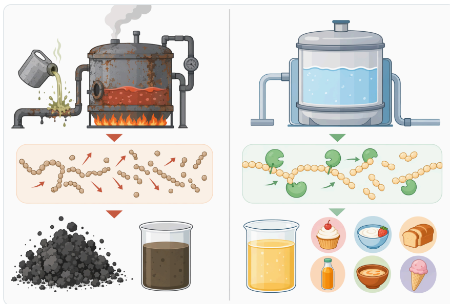
Figure 4. 산을 이용한 전분 가수분해와 비교할 때, 알파-아밀라아제 액화는 더 온화한 공정 조건, 보다 제어된 덱스트린 형성, 더 적은 원치 않는 부산물을 제공합니다.
