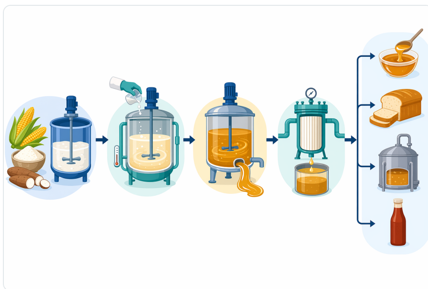
Figure 2. 식품용 전분 가공에서는 가열된 전분 슬러리에 중온성 알파-아밀라아제를 첨가하여, 이후의 정화 공정과 제품 배합 전에 전분을 액화합니다.
