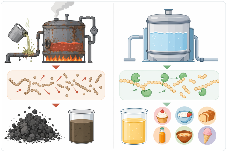
Figure 4. 산을 이용한 전분 가수분해와 비교할 때, 알파-아밀라아제 액화는 더 온화한 공정 조건, 보다 제어된 덱스트린 형성, 그리고 원치 않는 부산물 감소라는 장점을 제공합니다.
