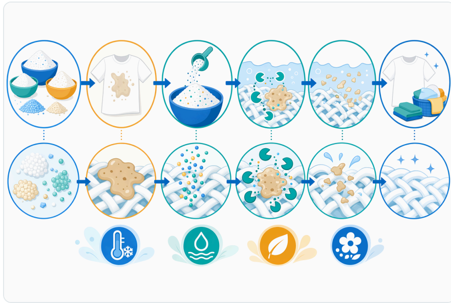
Figure 5. 在洗滌循環中，水會使膠質污漬水合，甘露聚糖酶擴散進入可接觸區域，聚合物鏈被切斷，洗滌系統再將鬆動的殘留物分散開來。
