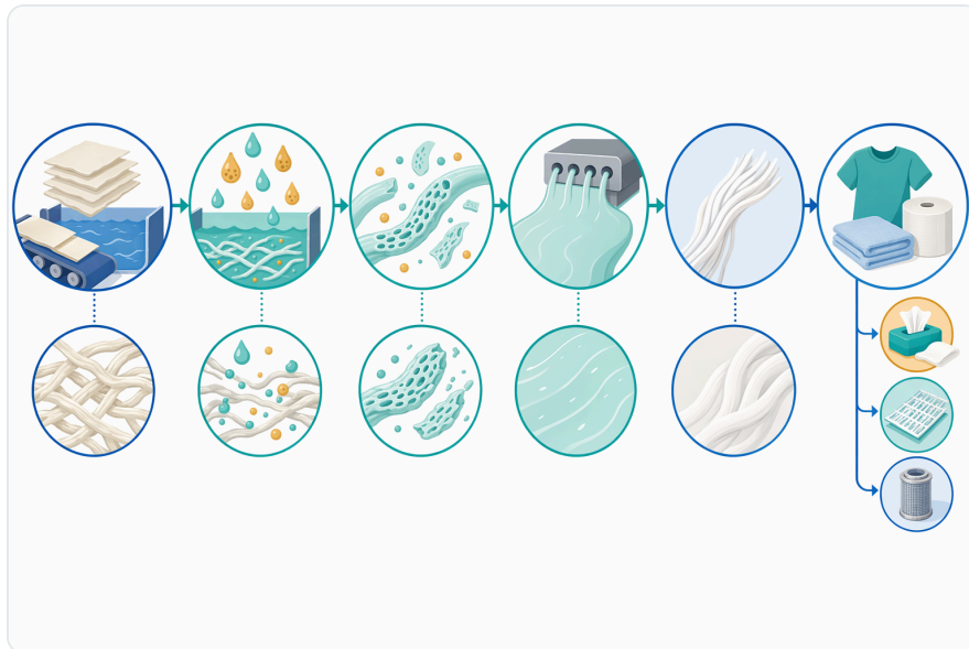
Figure 1. 활성화 효소는 NMMO 용해, 압출 및 셀룰로오스 재생 전에 수계 펄프 전처리 단계에서 적용된다.
