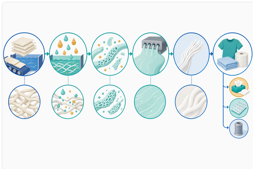
Figure 1. 활성화 효소는 NMMO 용해, 압출, 셀룰로오스 재생 전에 수계 펄프 전처리 단계에서 적용됩니다.
