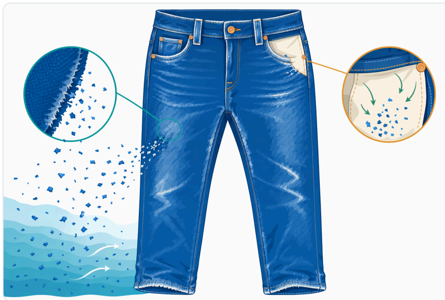
Figure 3. 눈에 보이는 데님 워시다운 효과는 느슨해진 미세섬유와 인디고를 포함한 조각들이 가장 쉽게 떨어져 나가는, 마찰이 많은 노출 부위에서 먼저 나타납니다.
