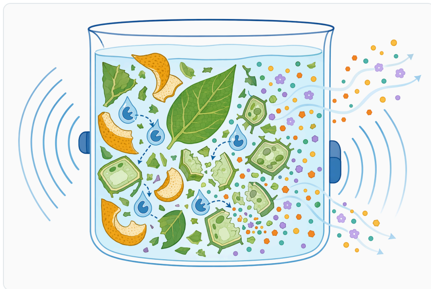
Figure 5. 果膠酶輔助萃取能削弱富含果膠的細胞壁屏障，促進成分釋放；同時，物理攪拌或超音波可改善質量傳遞。
