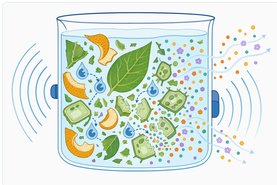
Figure 5. 펙티나아제를 이용한 추출은 펙틴이 풍부한 세포벽 장벽을 약화시켜 성분 방출을 개선하고, 물리적 혼합이나 초음파는 물질 전달을 향상시킵니다.
