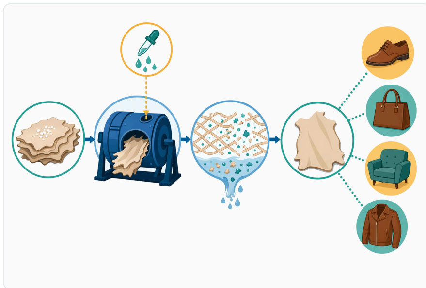
Figure 3. 제어된 가수분해는 펩타이드 결합 절단에서 시작해 단백질 장벽 감소, 섬유 개방 개선, 화학물질 확산 향상, 더 균일한 가죽 물성으로 이어질 수 있다.
