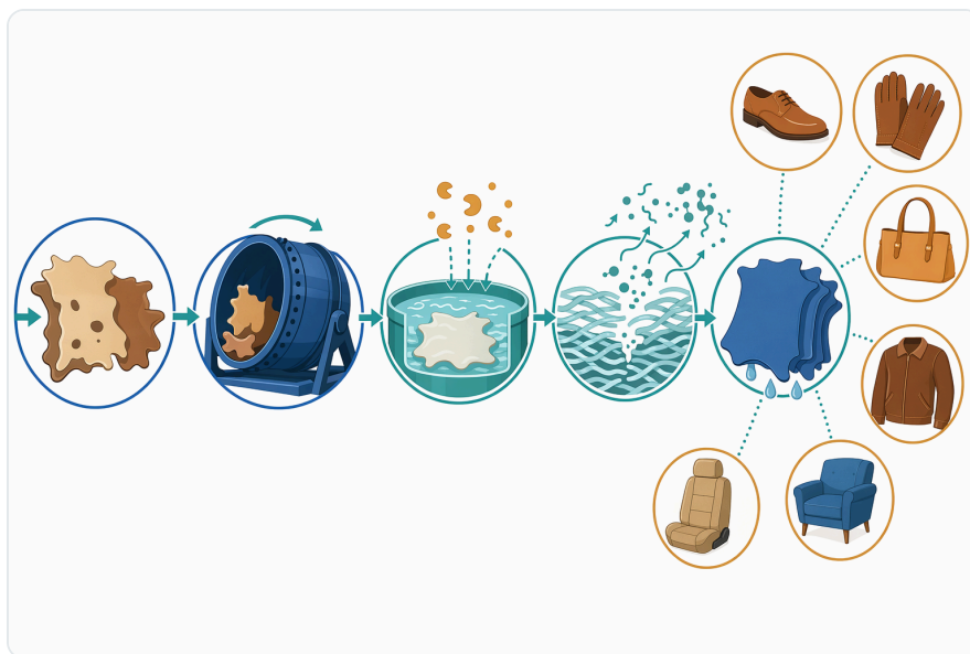
Figure 3. 胰蛋白酶軟化安排在浸灰與脫灰之後，並在浸酸、鞣製及鞣後作業之前進行。
