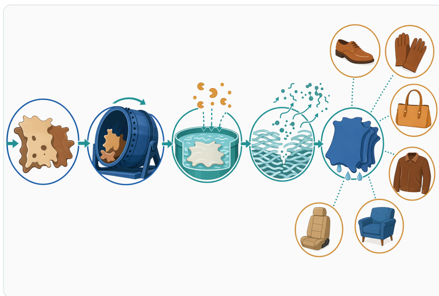
Figure 3. トリプシンによるベーキングは、石灰漬けと脱灰の後、ピックアップ、なめし、なめし後工程の前に位置づけられる。
