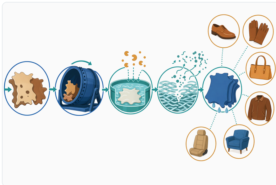
Figure 3. 트립신 베이팅은 석회 처리와 탈회 처리 후, 산침·무두질·무두질 후 공정 전에 이루어진다.
