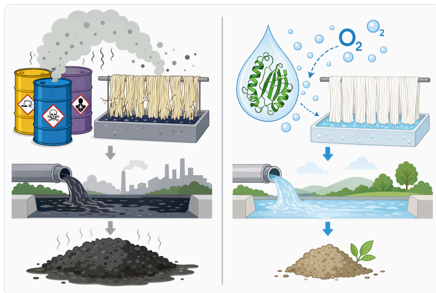
Figure 4. 강한 화학적 산화와 비교할 때, 라카아제 처리는 방향족 기질을 선택적으로 산화하면서 화학물질 사용량을 줄일 수 있습니다.
