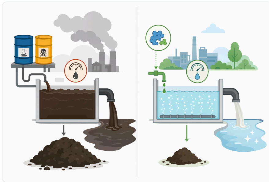
Figure 4. 더 가혹한 화학적 산화나 응집 처리와 비교할 때, 라카아제 처리는 더 온화한 조건에서 작동할 수 있으며 색을 유발하는 오염물질을 줄일 수 있습니다.
