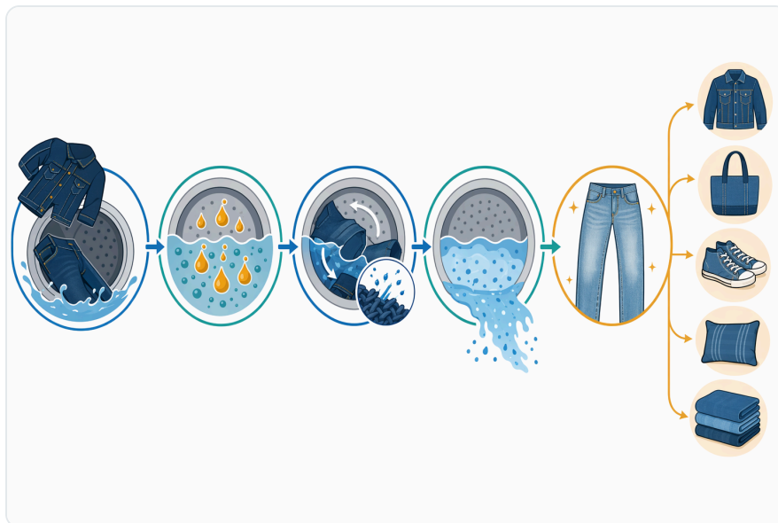
Figure 4. Hiện tượng lem màu trở lại xảy ra khi các hạt chàm được giải phóng không được giữ phân tán và xả trôi trước khi chúng bám lại lên những vùng denim sáng màu hơn.
