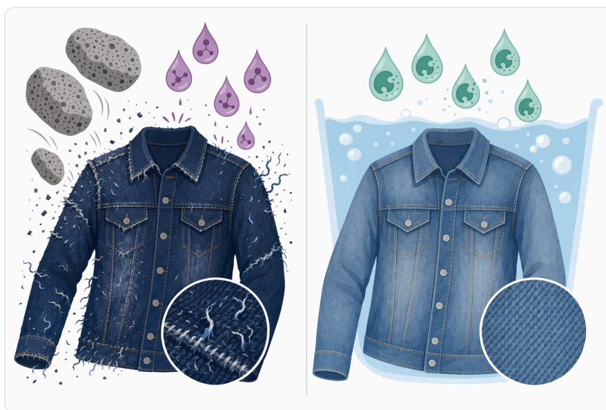
Figure 3. Sự phai màu dựa trên cellulase loại bỏ vật liệu bề mặt bông mang thuốc nhuộm, trong khi quá trình khử màu kiểu laccase diễn ra thông qua các biến đổi oxy hóa ở những nhóm mang màu của thuốc nhuộm để bị tác động.
