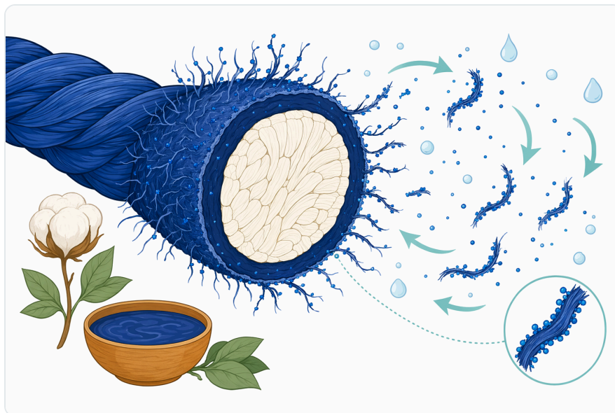
Figure 1. Hiện tượng phai màu chậm trong quá trình giặt denim bằng enzyme chủ yếu là hiệu ứng trên bề mặt, vì phần lớn màu xanh nhìn thấy tập trung gần bề mặt ngoài của sợi.
