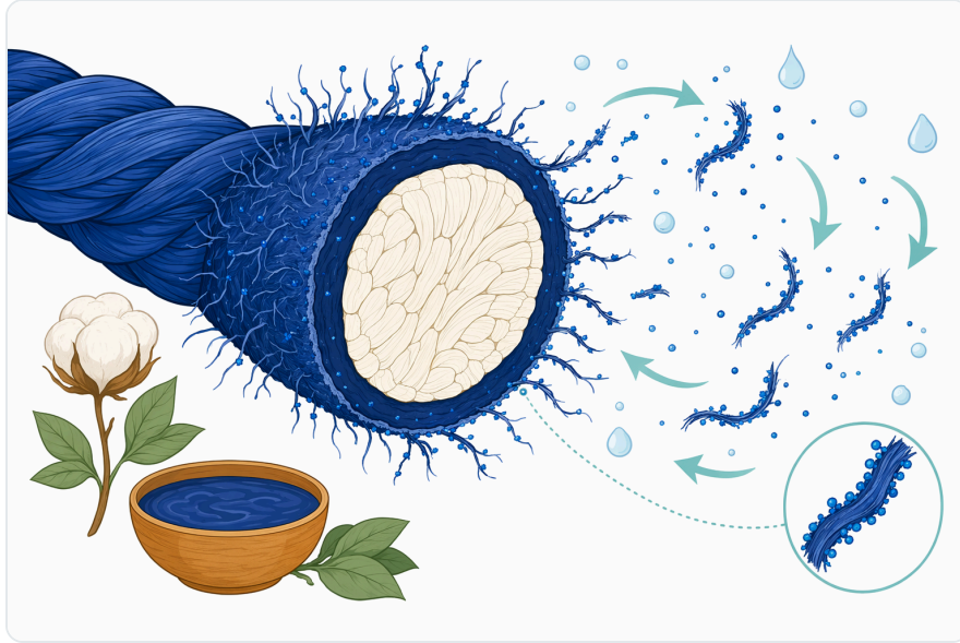
Figure 1. 효소를 이용한 데님 위상에서 인디고의 탈색은 주로 표면에서 일어나는 현상인데, 이는 눈에 보이는 푸른색의 상당 부분이 실의 바깥층 가까이에 집중되어 있기 때문이다.
