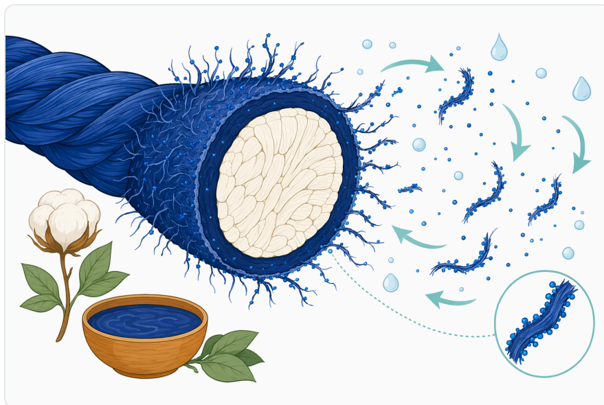
Figure 1. 효소를 이용한 데님 워싱에서 인디고 퇴색은 주로 표면에서 일어나는 현상인데, 눈에 보이는 파란색의 상당 부분이 실의 바깥쪽에 집중되어 있기 때문이다.
