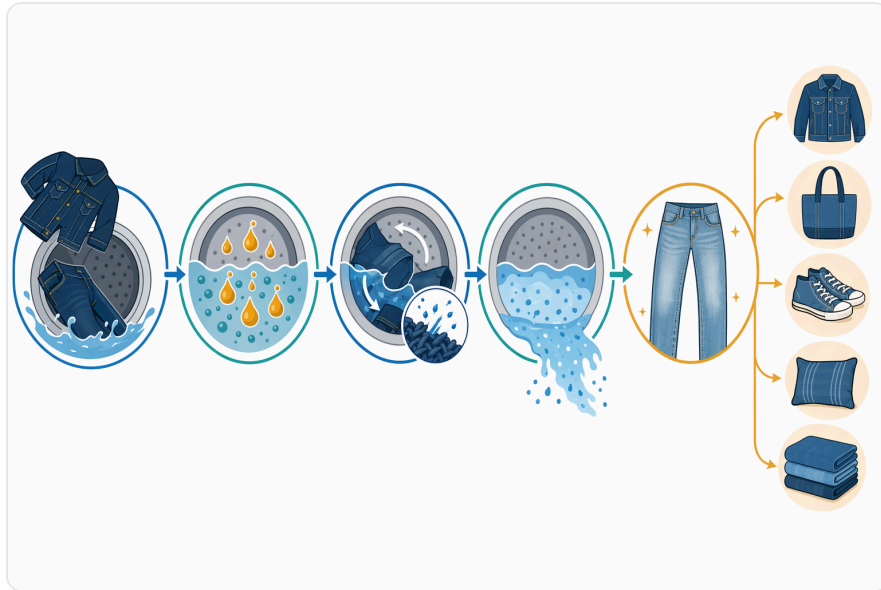
Figure 4. 백스테이닝은 떨어져 나온 인디고 입자가 충분히 분산되어 헹굼으로 제거되지 못하고, 더 밝은 데님 부위에 다시 달라붙을 때 발생한다.
