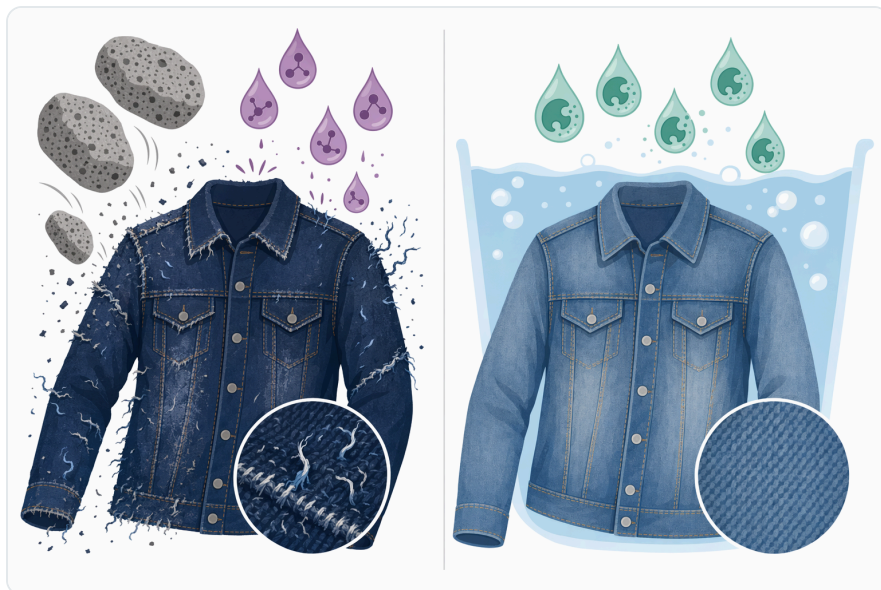
Figure 3. 셀룰라아제 기반의 색바램은 염료를 지닌 면 표면 물질을 제거하는 방식인 반면, 라카아제 유형의 탈색은 반응하기 쉬운 염료 발색단의 산화적 변화를 통해 작용한다.
