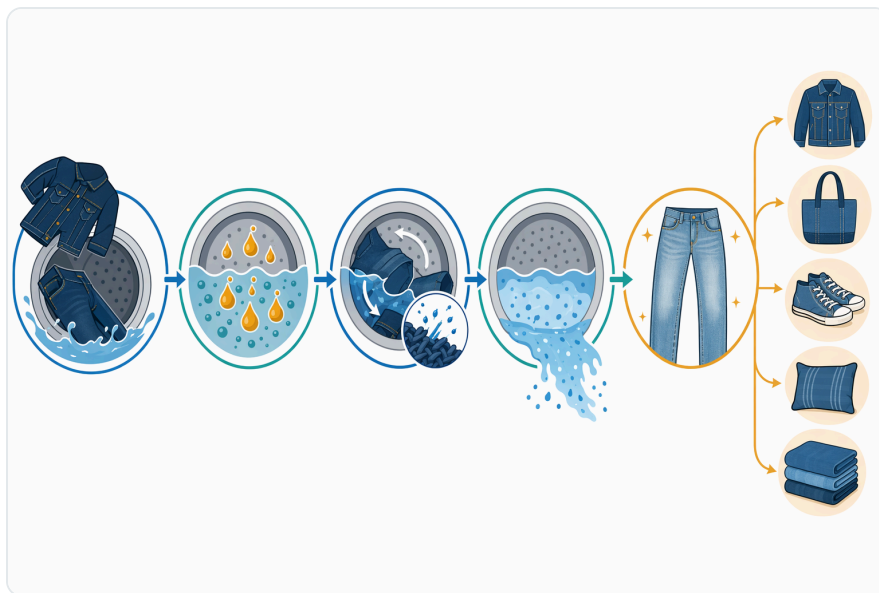
Figure 4. 백스테이닝은 떨어져 나온 인디고 입자가 분산된 상태로 유지되어 헹굼으로 제거되지 못하고, 더 밝은 데님 부위에 다시 달라붙을 때 발생한다.
