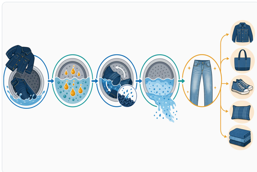
Figure 4. 백스테이닝은 떨어져 나온 인디고 입자가 잘 분산되어 행균으로 제거 되지 못하고, 밝은 데님 부위에 다시 달라붙을 때 발생한다.
