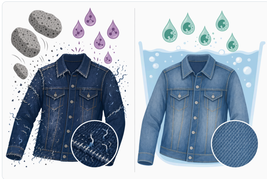
Figure 3. 셀룰라아제 기반 탈색은 염료를 포함한 먼 표면 물질을 제거하는 방식인 반면, 라카아제 계열의 탈색은 민감한 염료 발색단에 산화적 변화를 일으키는 방식으로 작용한다.
