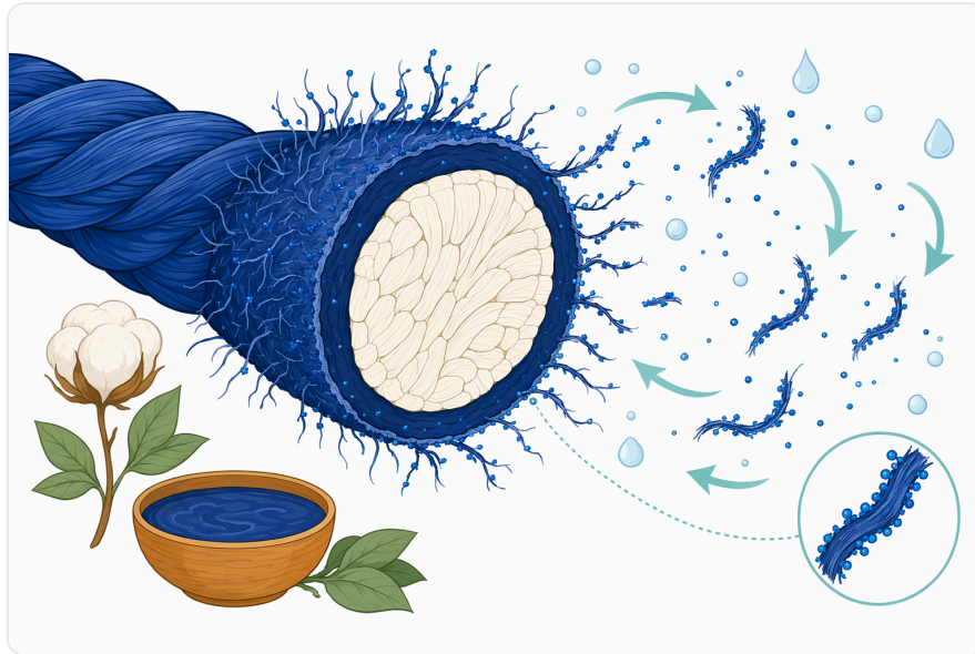
Figure 1. 효소 데님 워싱에서 인디고 탈색은 주로 표면에서 일어나는 현상인데, 눈에 보이는 파란색의 상당 부분이 실의 바깥쪽에 집중되어 있기 때문이다.
