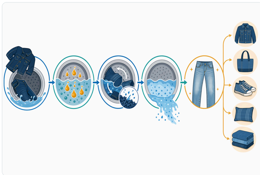
Figure 4. 백스테이닝은 떨어져 나온 인디고 입자가 충분히 분산된 상태로 유지되어 헹굼 과정에서 제거되지 못하고, 더 밝은 데님 부위에 다시 달라붙을 때 발생한다.
